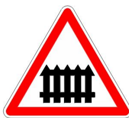
Passage à niveau muni de barrières
