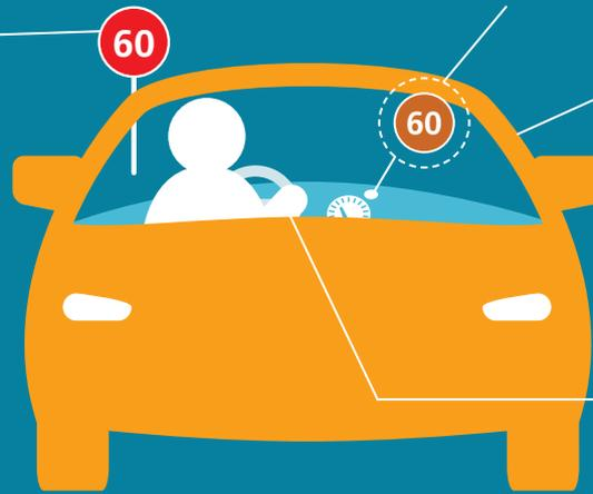
3. Le système limite alors la vitesse maximum du véhicule en fonction de cette vitesse réglementaire.
